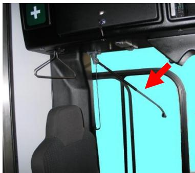
← Zur Fahrgastinformation ist eine Ausrufanlage (Mikrofon ⇒ Lautsprecher) zu installieren, die unabhängig von anderen Einrichtungen (z.B. IBIS, Fahrzeugechrechner) funktioniert. Die Verwendung von Stab-Mikrofonen (z.B. Mymex TA-104-H) wird empfohlen.
