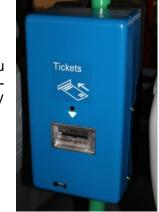
Die Weiterschaltung des Entwerters hat automatisch zu erfolgen. Die Nachlaufzeit bei ausgeschaltetem Motor oder ausgeschalteter Zündung hat mindestens 20 Minuten zu betragen.
