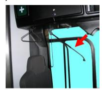
← Zur Fahrgastinformation ist eine Ausrufanlage (Mikrofon ⇒ Lautsprecher) zu installieren, die unabhängig von anderen Einrichtungen (z.B. IBIS, Fahrzeugrechner) funktioniert. Die Verwendung von Stab-Mikrofonen (z.B. Mymex TA-104-H) wird empfohlen.
