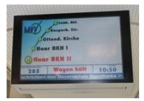
Die Bildschirme werden hinsichtlich der Linieninformationen über den Fahrzeugrechner (Datensatz 21, Geräteadresse 10) angesteuert.
