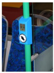
Für die Öffnung selbsttätiger Betriebstüren sind **innen**, rechts und links, in unmittelbarer Nähe zu den Türen, Taster mit programmierbarem LCD-Display anzubringen (z.B. Hersteller Captron, Modell HWT3-D62P-10/CP04). Diese Taster müssen die Funktion eines Haltewunschtasters und eines Türöffners dabei in sich vereinen:
