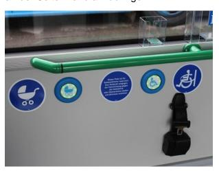
An der Seitenwand im Bereich der Sondernutzungsfläche bei Tür 2 ist in Reichweite der Rollstuhlfahrer ein spezieller Taster für die Anforderung der Klapprampe anzubringen (Symbol "Rollstuhl"). Dieser Taster soll sowohl als Haltewunschaster dienen als auch mit einem besonderen Signal (optisch oder akustisch) am Fahrerarbeitsplatz hinterlegt sein, um die Aufmerksamkeit des Fahrpersonals für diese Personengruppe zu gewährleisten.
