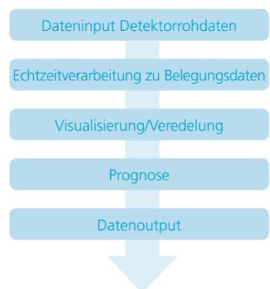
Abbildung 9: Verarbeitungsprozess der erhobenen Detektionsdaten.
