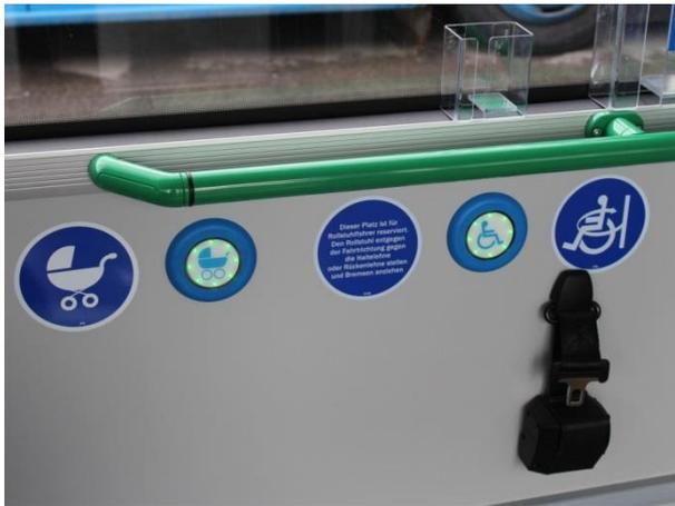
An der Seitenwand im Bereich der Sondernutzungsfläche bei Tür 2 ist in Reichweite der Rollstuhlfahrer ein **spezieller Taster für die Anforderung der Klapprampe anzubringen** (Symbol „Rollstuhl“). Dieser Taster soll sowohl als Haltewunschaster dienen als auch mit einem besonderen Signal (optisch oder akustisch) am Fahrerarbeitsplatz hinterlegt sein, um die Aufmerksamkeit des Fahrpersonals für diese Personengruppe zu gewährleisten.
