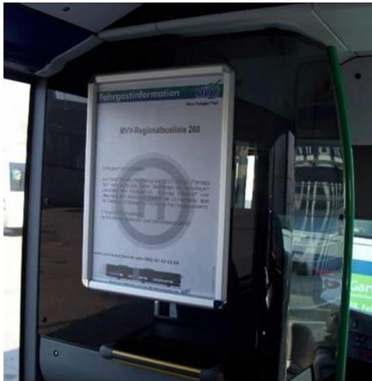
Darüber hinaus ist ein Klapprahmen (DIN A2) zur Aufnahme von **MVV-Plakaten** an der Rückseite der Fahrerkabine anzubringen und jeweils ausschließlich und durchgehend mit Informationen und Hinweisen des MVV bzw. des Aufgabenträgers zu bestücken (←).
