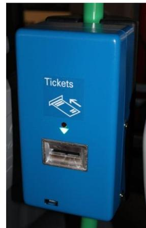
Die Weiterschaltung des Entwerter hat automatisch zu erfolgen. Die Nachlaufzeit bei ausgeschaltetem Motor oder ausgeschalteter Zündung hat mindestens 20 Minuten zu betragen.
