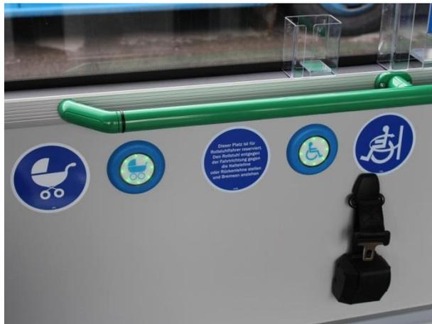
An der Seitenwand im Bereich der Sondernutzungsfläche bei Tür 2 ist in Reichweite der Rollstuhlfahrer **ein spezieller sensorischer Taster für die Anforderung der Klapprampe anzubringen** (blaues Symbol „Rollstuhl“ auf weißem Hintergrund). Dieser Taster soll sowohl als Haltewunschtaster dienen als auch mit einem besonderen Signal (optisch oder akustisch) am Fahrer Arbeitsplatz hinterlegt sein, um die Aufmerksamkeit des Fahrpersonals für diese Personengruppe zu gewähr-
