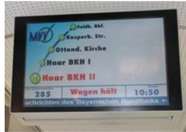
Soweit in Anlage A6 angegeben, sind die Fahrzeuge mit weiteren TFT-Bildschirmen auszustatten. Bei Solobussen sind zwei Bildschirme (Rücken an Rücken) über dem Durchgangsbereich zum hinteren Fahrzeugteil anzubringen. Bei Gelenkbussen ist ein weiterer Bildschirm vor dem Gelenk nach vorne weisend einzubauen.
