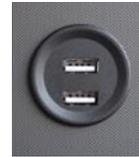
Sollten die USB-Ladebuchsen für den Fahrgast nicht leicht zu erkennen sein, muss eine Kennzeichnung erfolgen.
